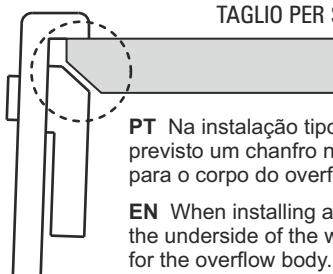
**PT** Na instalação tipo encastrar por cima deve ser previsto um chanfro no plano inferior da bancada, para o corpo do overflow.
